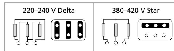
a) 220-240V角接/380-420V星接 – 可以标注为230/400V (3 kW及以下电动机)，适应于380-420V直接线起动。
