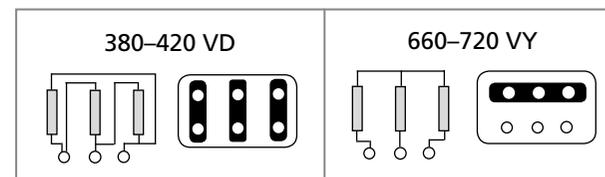
b) 380-420V角接/660-720V星接 – 可以标注为400V 角接 (4 kW及以上电动机)，适应于380-420V星/角接和660-720V直接线起动。
